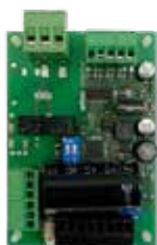
EVDRIVE униполярный & импульсный 12 VAC power supply, 3 I/O, INTRABUS, TTL and RS-485 ports
