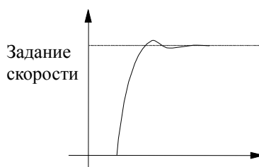
Рис. 6-15. Выходной сигнал с оптимизированными динамическими свойствами
