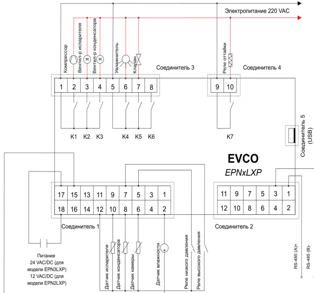
**ВНИМАНИЕ:** реле «Оттайка» и реле «Клапан» работают **синхронно!**
