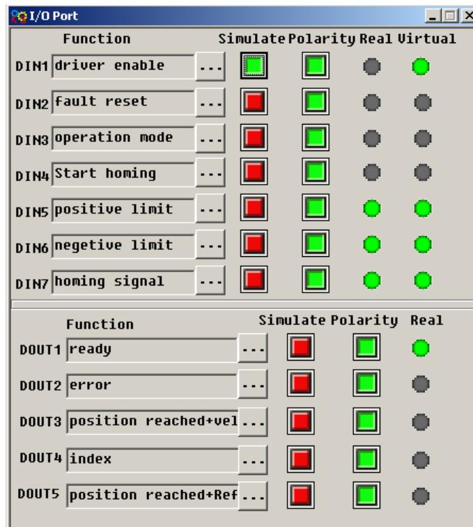
В режиме 7 по умолчанию определяется сигнал фазы Z, далее положение привода устанавливается на 0, и текущая позиция является базовой. Картинка с компьютера будет выглядеть так:
