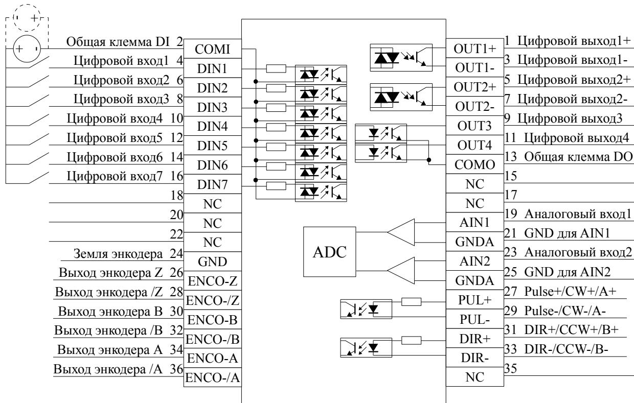
Рисунок 3-7 Схема подключения разъёма X1 сервоусилителя CD2
