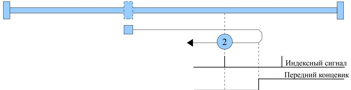
**Способы 3 и 4: Поиск нулевой точки по включению нулевого выключателя и индексному сигналу**
