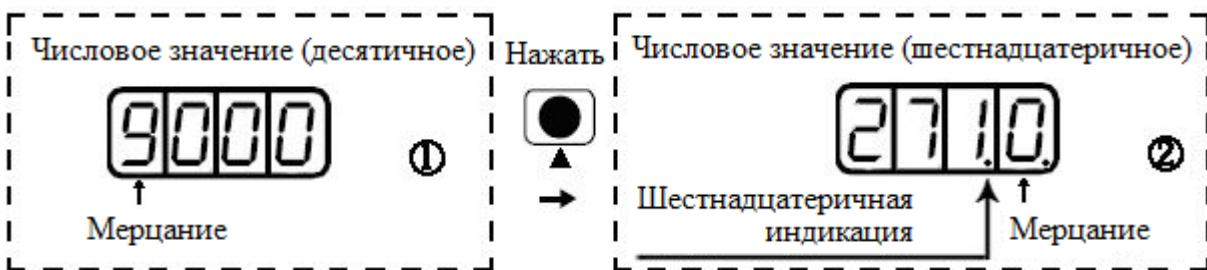
**Пример 4-2: Установка скорости в 1000 RPM/-1000 RPM через изменение отдельных разрядов**
