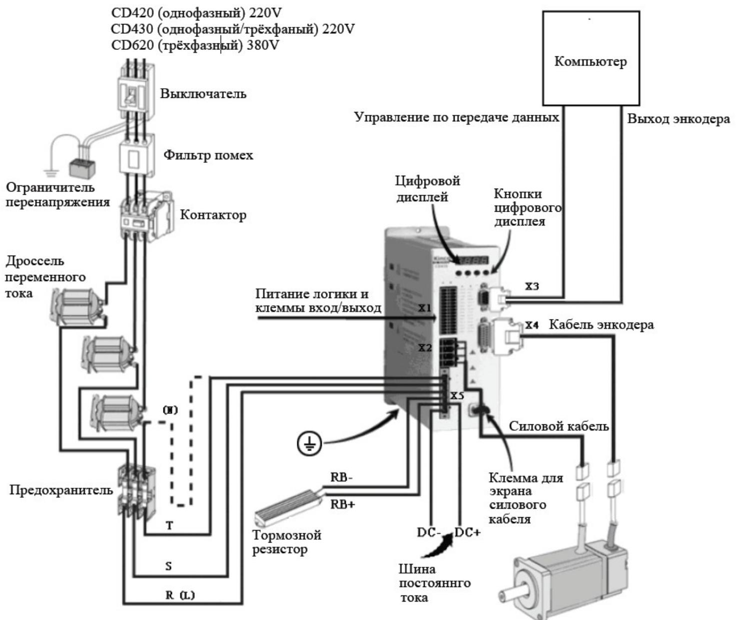
Рисунок 3-1 Схема внешнего подключения servoусилителя CD
