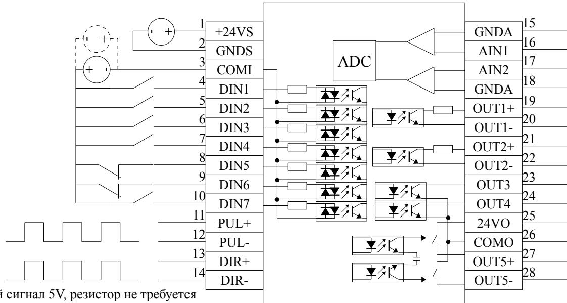
2. Схема подключения сервоусилителя CD2 в импульсном режиме управления
