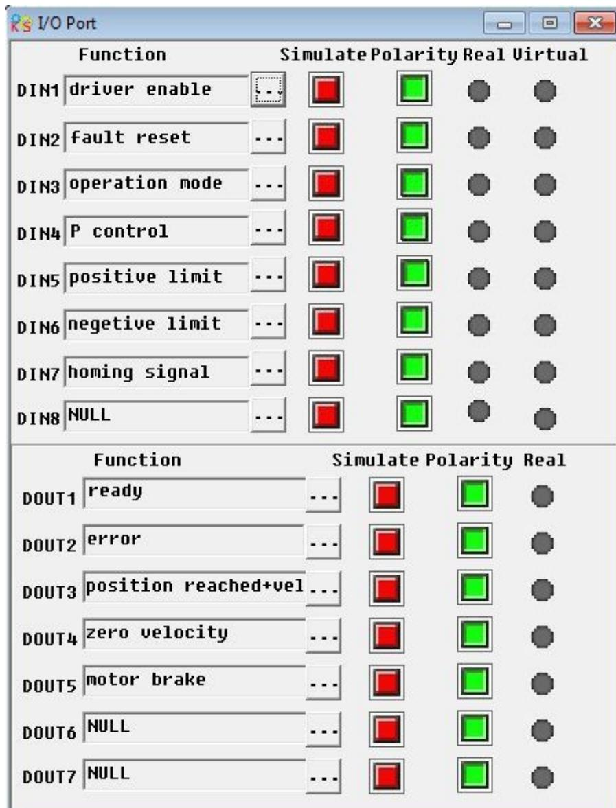
**Пример 5-2: Использование программного обеспечения KincoServo для настройки функций порта ввода / вывода**
