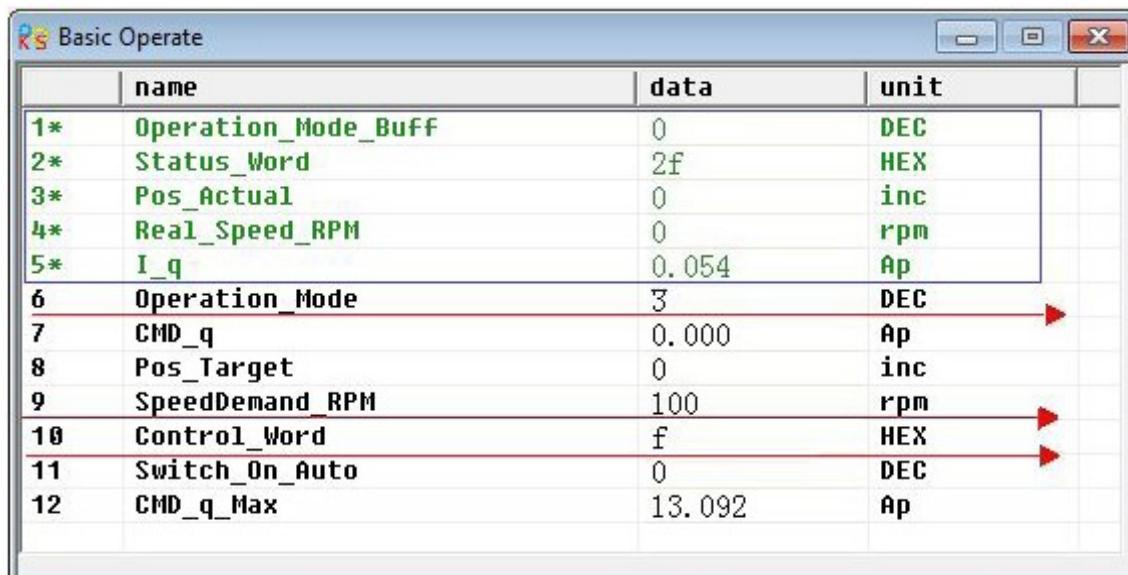
**Пример 5-1: Использование программного обеспечения KincoServo для управления сервоприводом, работающим в ручном режиме контроля скорости.**
