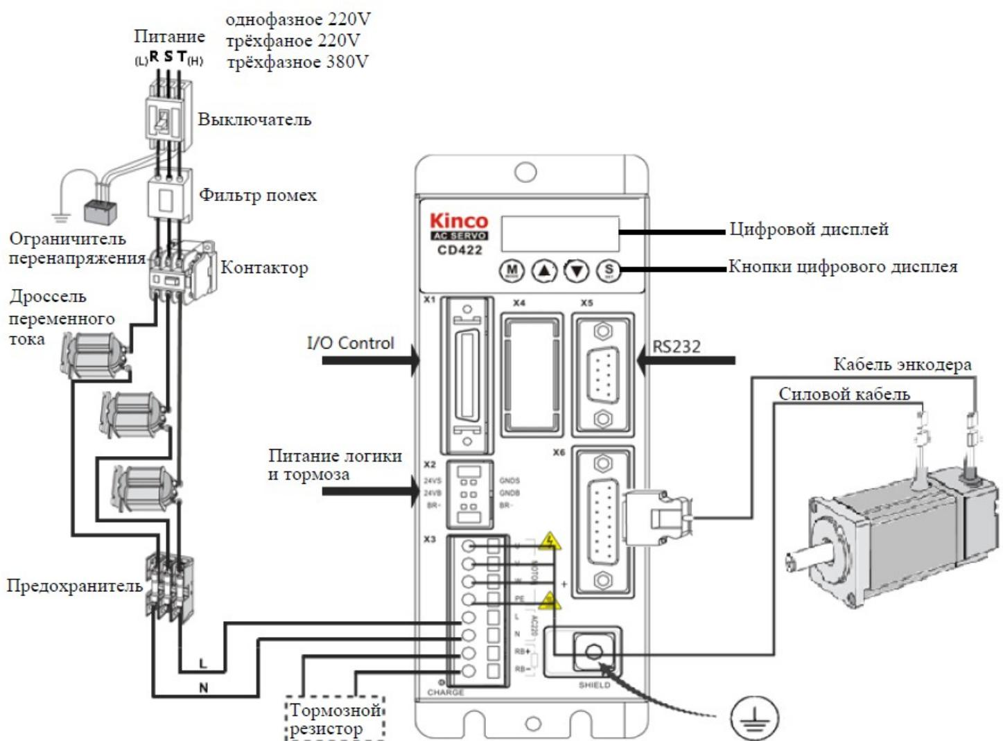
Рисунок 3-5 Схема подключения сервоусилителя CD2
