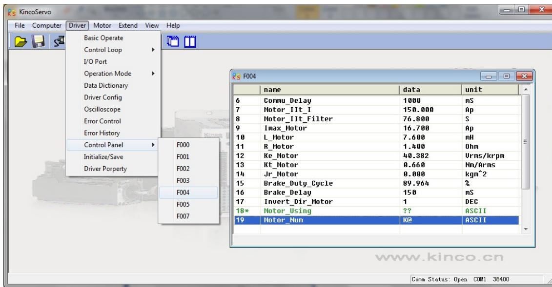
Рисунок 6-2 Настройка типа двигателя с помощью программного обеспечения
