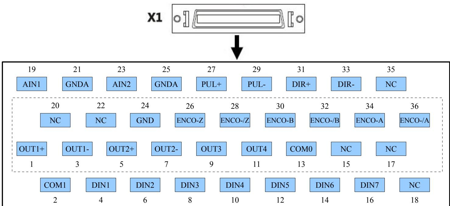
Рисунок 3-6 Разъём X1 сервоусилителя CD2
