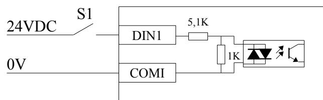
Рисунок 7-1 Настройка полярности дискретного входа DIN1
