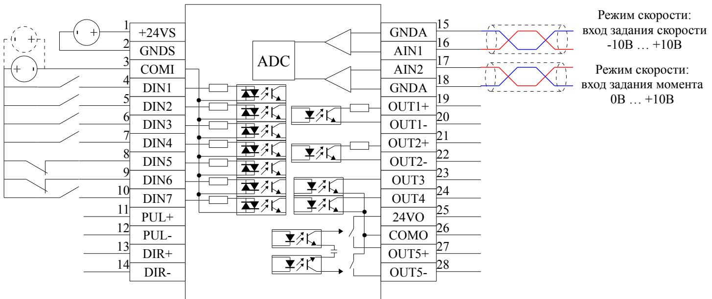
2. Схема подключения сервоусилителя CD2 в режиме управления скоростью
