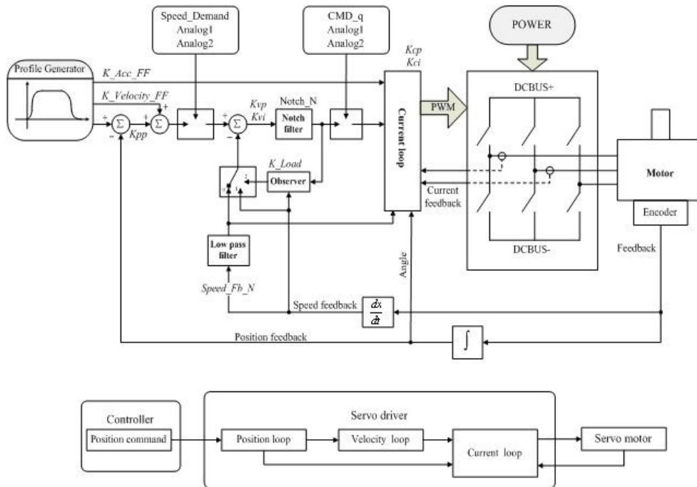
Рисунок 9-1 Схема регулирования контура управления
