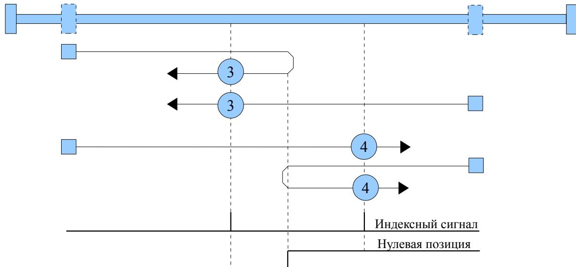
**Способы 5 и 6: Поиск нулевой точки по выключению нулевого выключателя и индексному сигналу**
