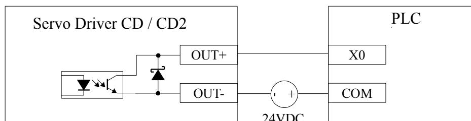
2. Схема подключения PNP (только OUT1, OUT2 и OUT7 поддерживают эту схему)
