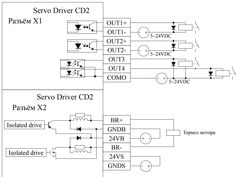
**Примечание:** При использовании выходов OUT3 и OUT4 подключите общую клемму COMO. При использовании выхода OUT5 подключите внешний источник питания к клеммам 24VO и COMO. Сервоусилитель CD2 не имеет выхода OUT5, поэтому для подключения тормоза мотора используйте клеммы 24VB, COMB, BR+, BR-.
