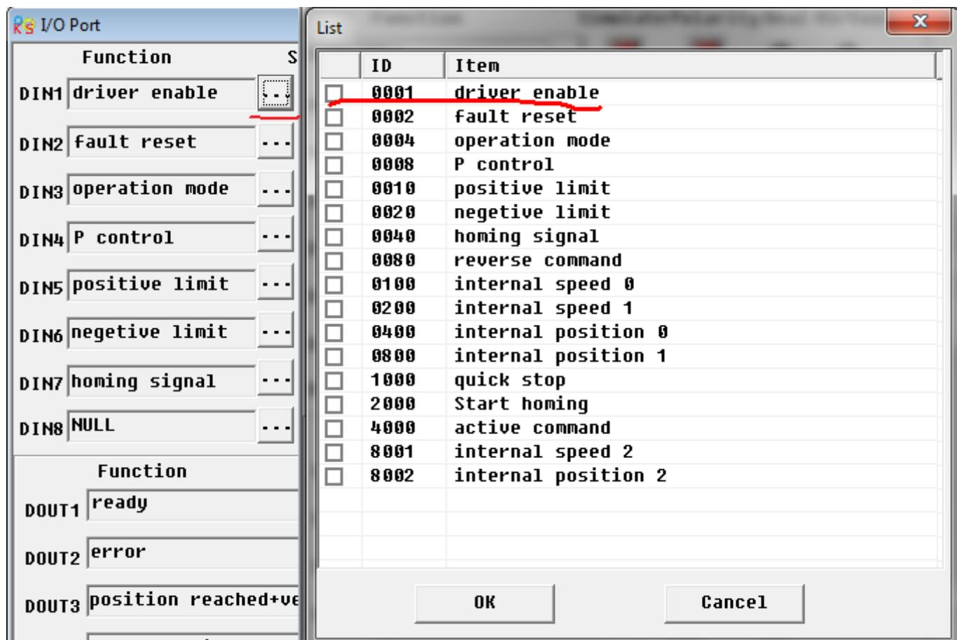
**Шаг 2:** Установите все функции других портов ввода / вывода с аналогично шагу 1. Затем выберите Driver -> Initialize / Save и нажмите кнопку "Save control parameters". Окончательные параметры портов ввода / вывода показаны на следующем рисунке:
