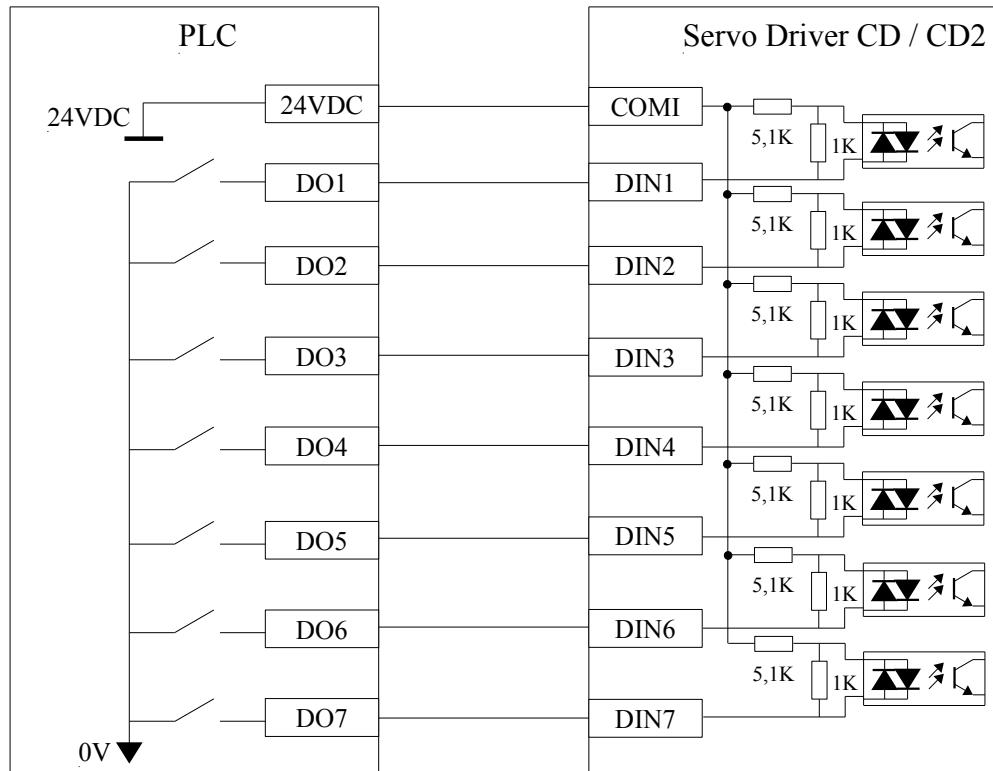
2. Схема подключения PNP (с контроллером, который поддерживает выход высокого уровня)
