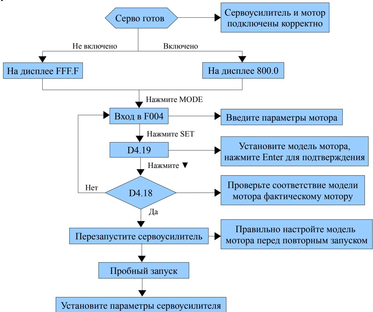
Рисунок 6-1 Блок схема настройки типа двигателя с помощью кнопок
