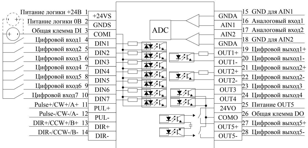
Рисунок 3-3 Подключения к разъему X1
