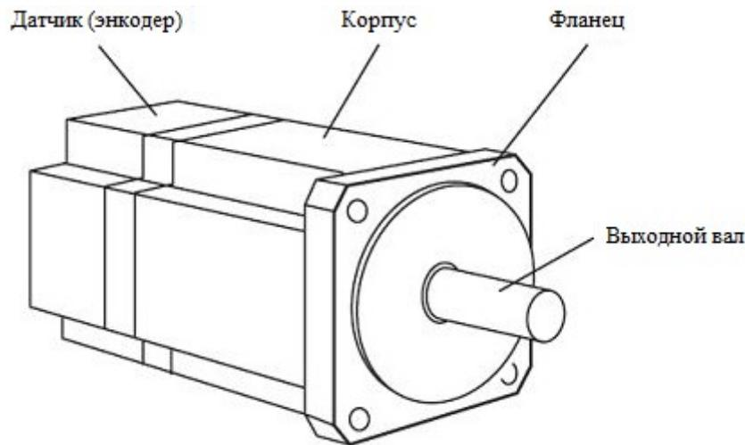
Рисунок 1-5 Наименования элементов сервомотора (тормоз отсутствует)
