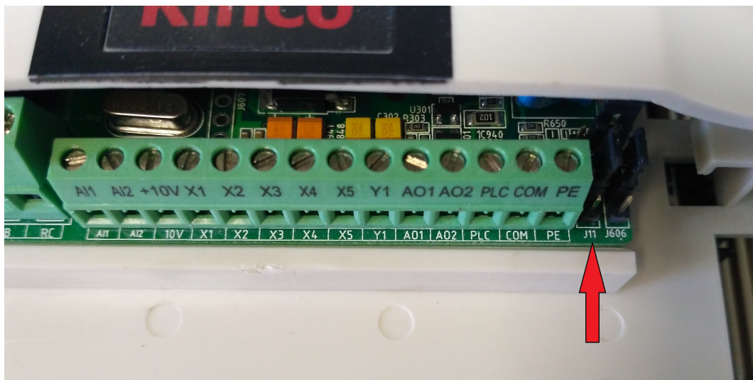
Рис.1а Конфигурация аналогового входа для CV100
