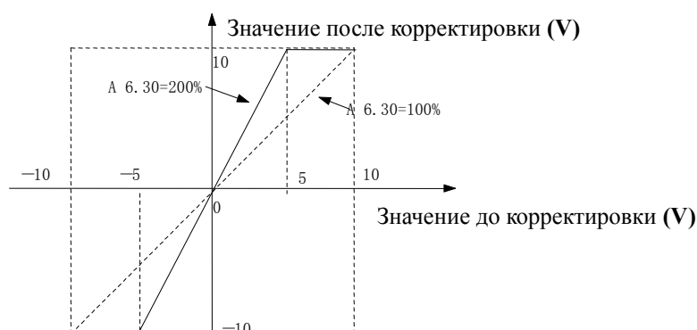
Рис. 6-31 Зависимость аналогового выхода от усиления
