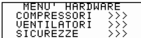
Характеристики такого типа собраны в отдельных внутренних меню, с целью разделения компрессоров, вентиляторов и устройств безопасности между собой.
