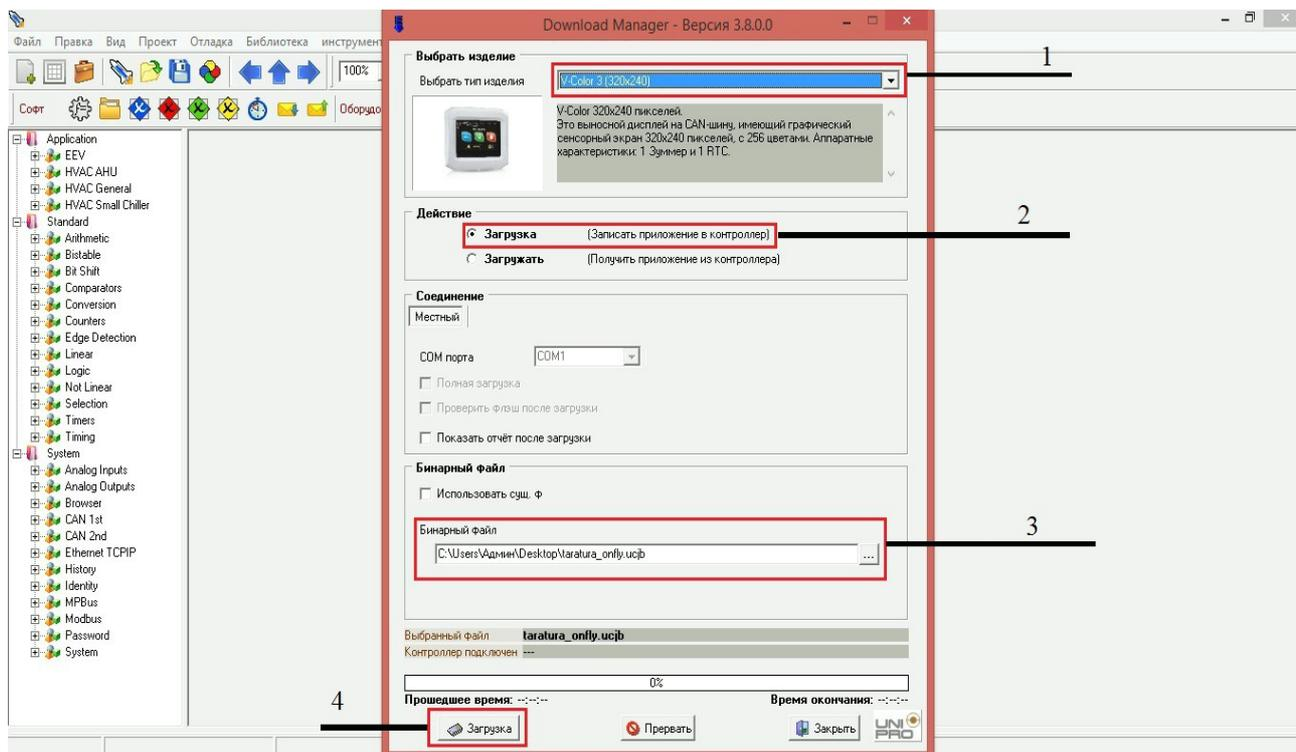
Рисунок 2- Последовательность действий для загрузки в панель оператора файла с функцией калибровки сенсора.
