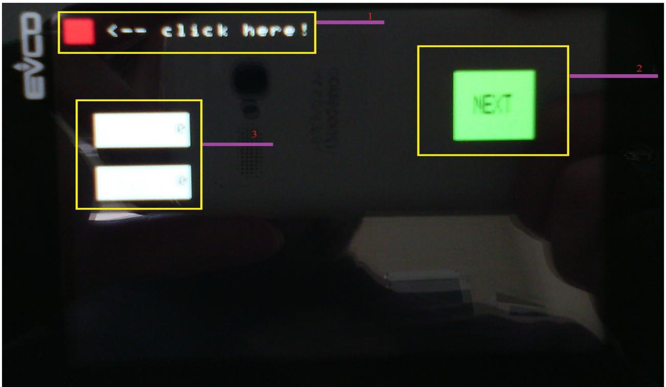
Рисунок 3 -Иллюстрирует процесс калибровки сенсора панели оператора.
