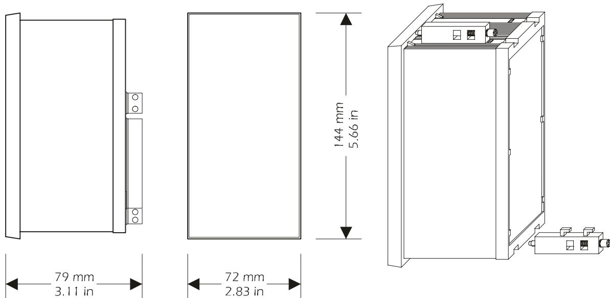
При монтаже с винтовыми скобами, регулируйте силу затяжки, чтобы не повредить корпус и винтовые скобы.
