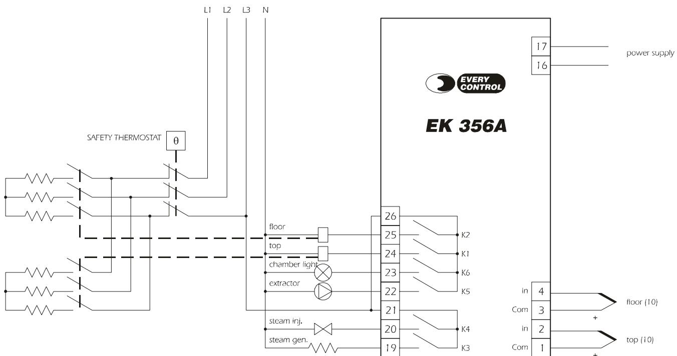
**Примечание:** (10) обеспечить датчик с защитой, способной защитить его от контакта с металлическими частями или использовать изоляцию датчиков.
